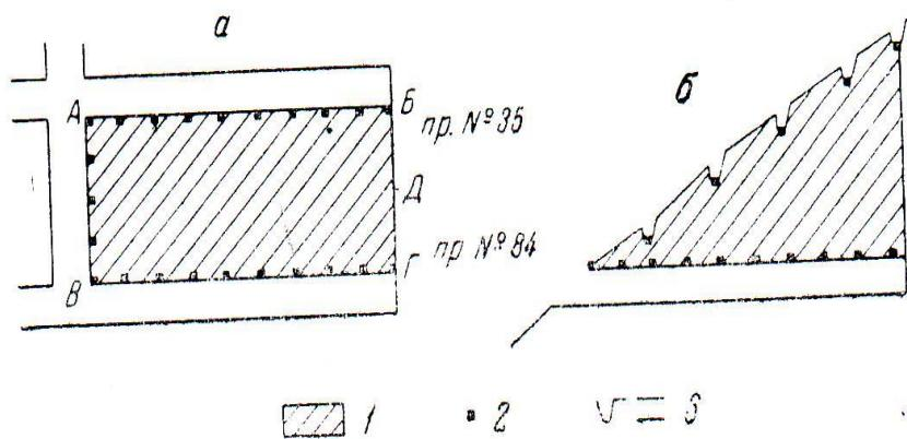
а – оконтуренность с трех сторон; б – оконтуренность с двух сторон; 1 – площадь подсчетного блока; 2 – место взятия пробы; 3 – горные выработки.
