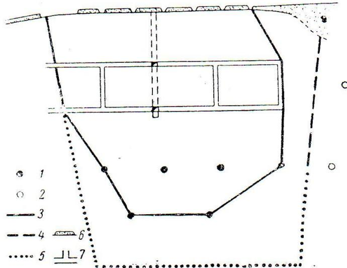
Оконтурирование кругопадающего тела полезного ископаемого для подсчетов запасов на вертикальном продольном разрезе: 1 – скважины, пересекшие тело полезного
