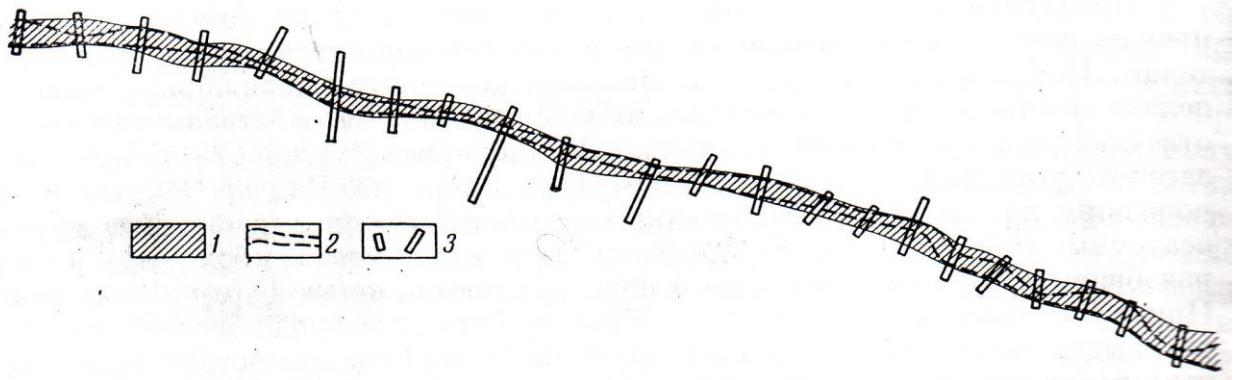
1- кварц – сульфидная жила; 2 – контур подсчета запасов, выделенный по данным опробования; 3- канавы
