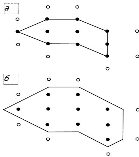
Рис.2. Оконтуривание рудного тела на горизонтальной проекции:
