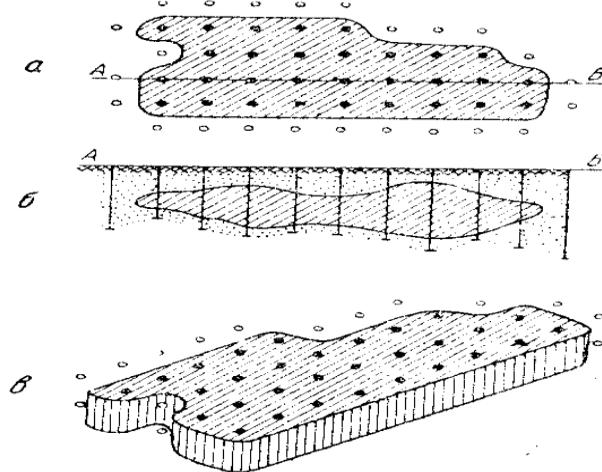
а – план рудного тела; б – разрез по линии АБ;
