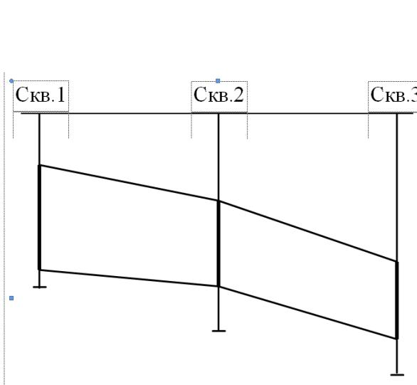
Рис.1. Оконтуривание по опорным точкам в разрезе. Жирными линиями выделены рудные пересечения от точки входа в рудное тело до точки выхода из него
