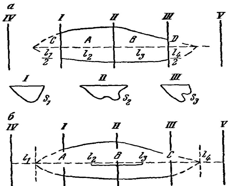
Рис. 83. Схема подсчета запасов методом параллельных разрезов
