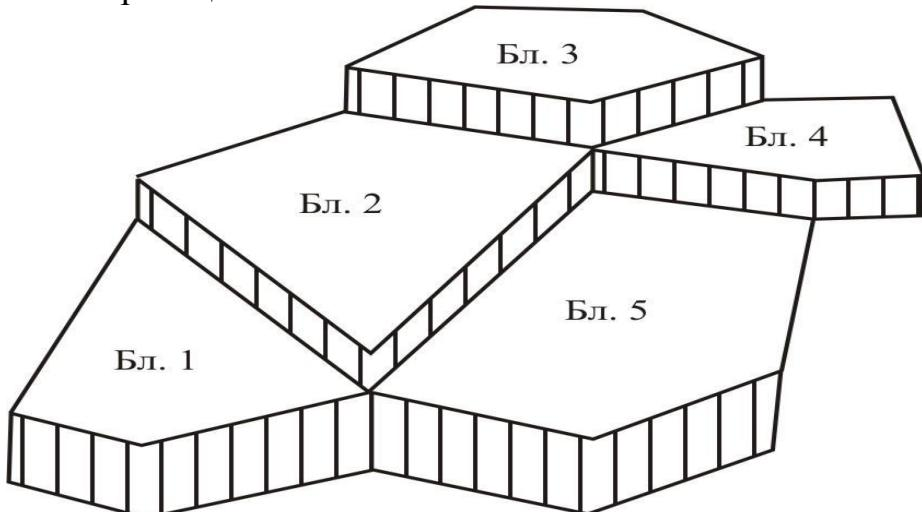
Преобразование тела полезного ископаемого в группу сомкнутых, разновеликих фигур при подсчете запасов по способу геологических блоков.
