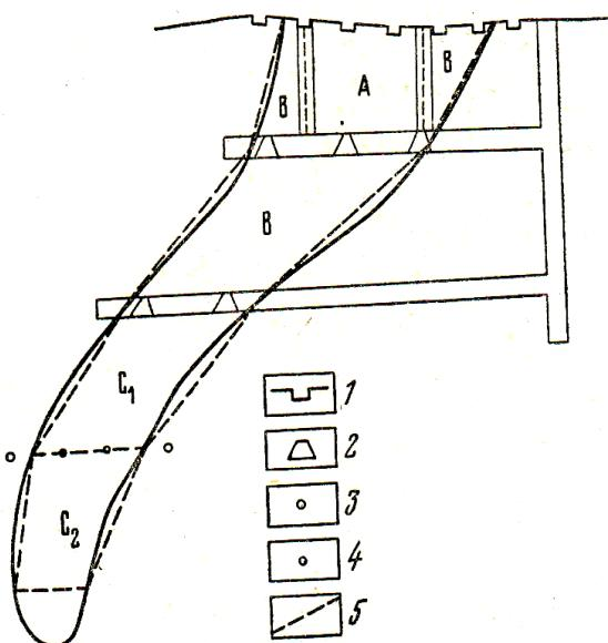
Схема выделения геологических блоков по степени разведанности рудного тела. 1 – канавы, 2 – орты; 3 – законтурные скважины; 4 – рудные скважины; 5 – границы подсчетных блоков.
