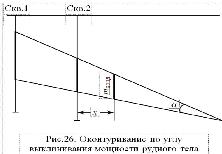
Рис.26. Оконтурирование по углу выклинивания мощности рудного тела
