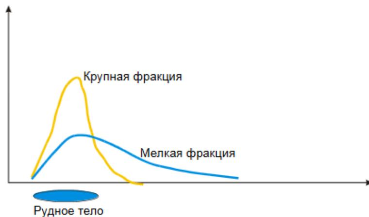
*Рис. 15. Изменение содержания рудного элемента в потоке рассеяния в зависимости от гранулометрического состава пробы*
