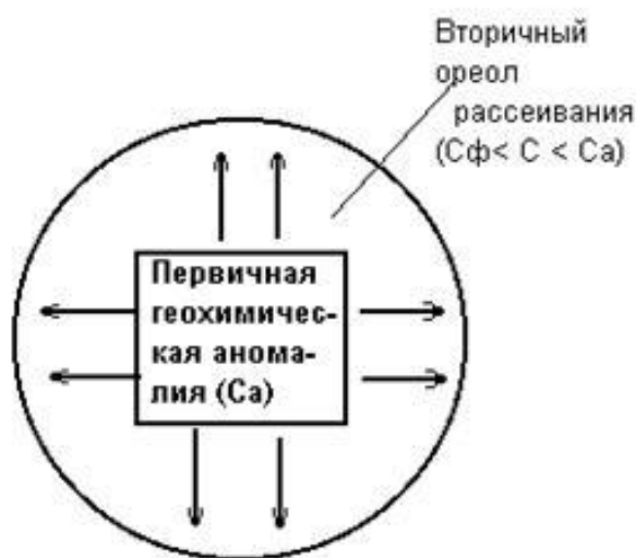
Рис. Вторичный ореол и потоки рассеивания аномалии:
