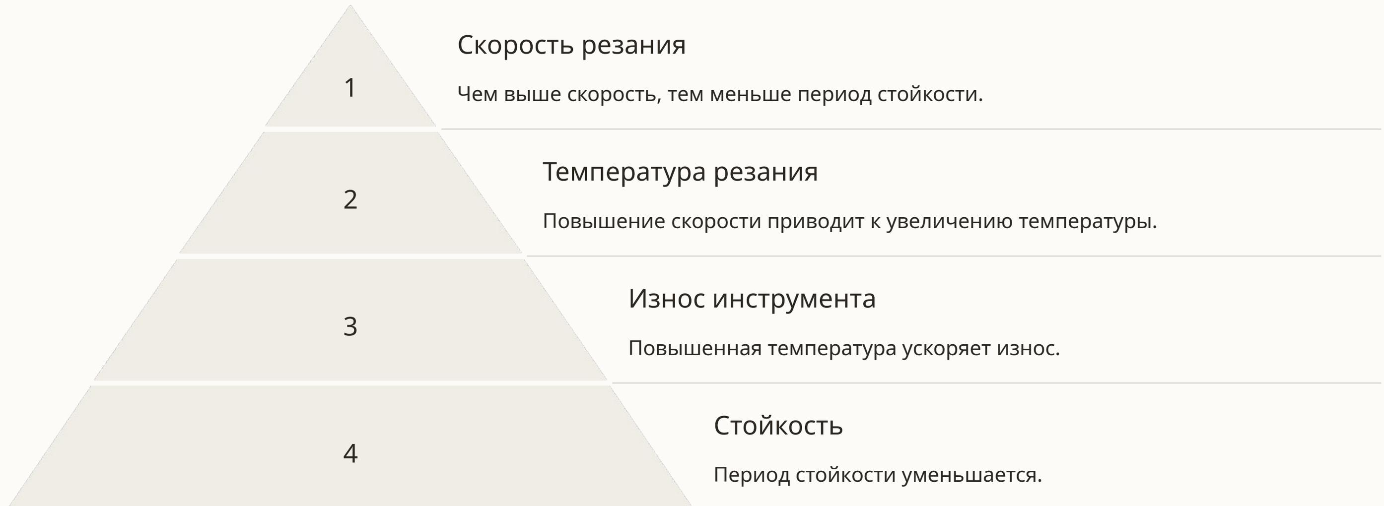
Существует обратная зависимость между скоростью резания и периодом стойкости инструмента. Повышение скорости приводит к увеличению температуры резания, что ускоряет износ инструмента, сокращая его период стойкости.
