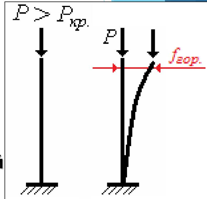
При этом стержень **обязательно** будет изгибаться в **плоскости минимальной жесткости**. Это легко продемонстрировать на примере обычной линейки: как бы мы не поворачивали ее поперечное сечение по отношению к сжимающей силе – линейка всегда будет изгибаться относительно оси, параллельной большей из сторон прямоугольника.
