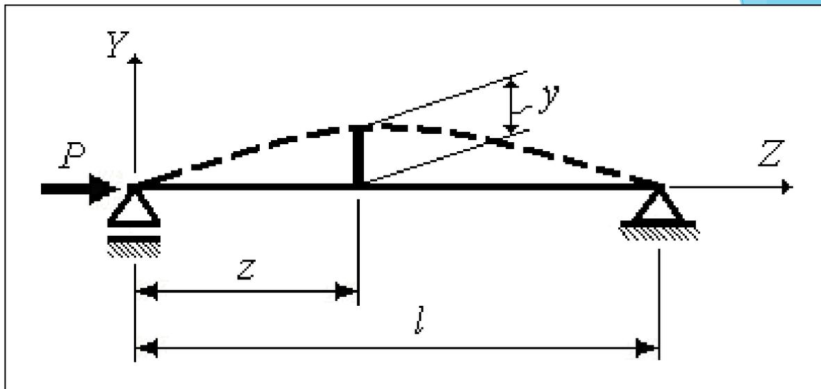
Под действием сжимающей силы определенной величины стержень изогнется и в его поперечных сечениях возникнет изгибающий момент  $M = P y$ .
