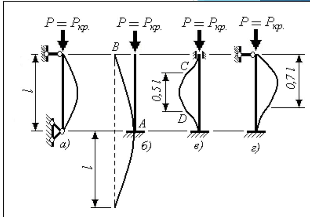
Таким образом, на **двух длинах** стержня получим синусоиду – как в основном случае закрепления. Для этого случая критическая сила будет равна критической силе для основного случая при длине стержня  $2l$ .
