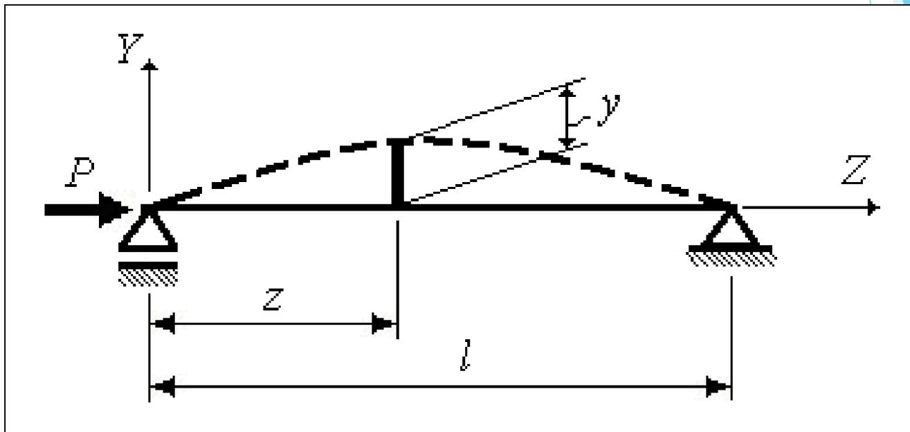
Определим условия, при которых возможно равновесие стержня с изогнутой осью при малых прогибах.
