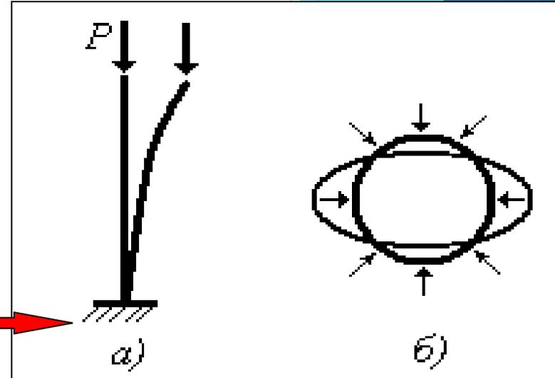
**б)** конструкция продолжает выполнять свои основные функции после потери ею устойчивости, например обшивка самолета или потеря устойчивости одним из стержней фермы;
