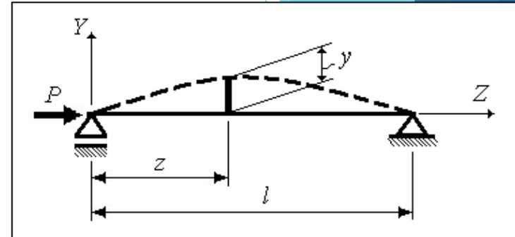
Получаем формулу для определения **критической силы**
