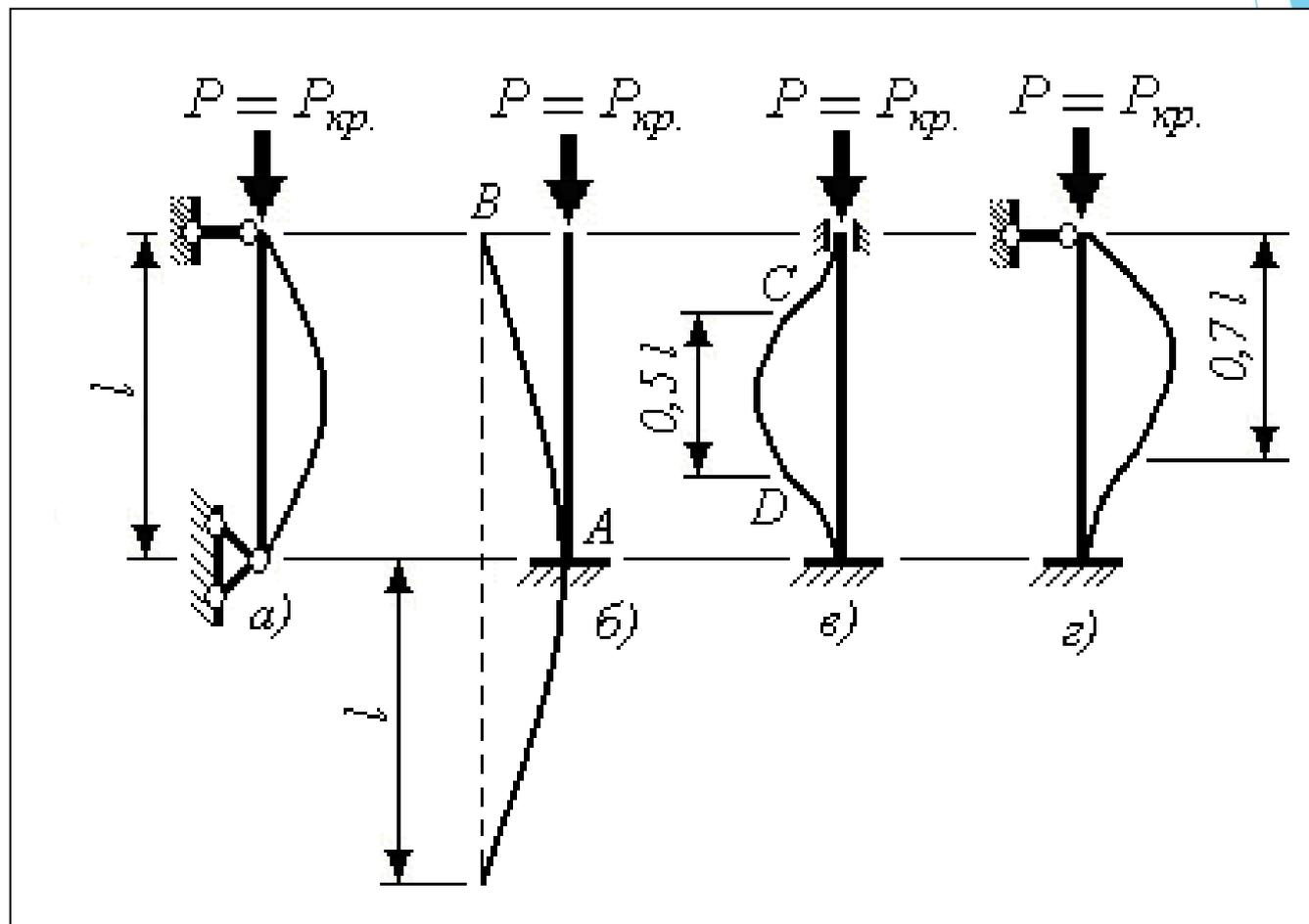
Один конец стержня жестко закреплен, а второй свободен (рис. б).
