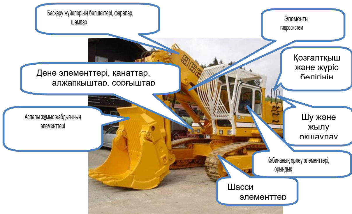
Сурет. 7. Жол-құрылыс машиналарын өндіру және жөндеу кезінде ПКМ қолданудың негізгі салалары
