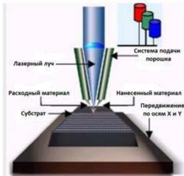
Сурет. 1. Тікелей лазерлік аддитивті бөлшектерді құру схемасы (CLAD)
