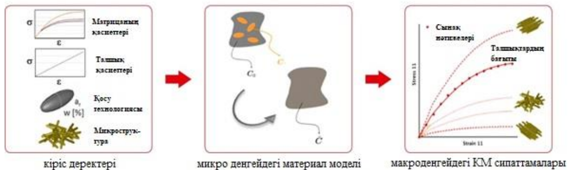
Сурет 1 – Композициялық материалдардың сипаттамаларын анықтауға арналған микродеңгейлі тәсіл
