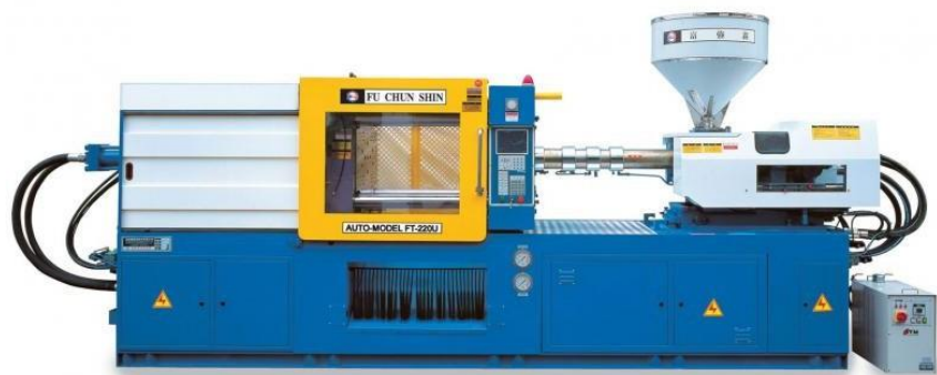
Сурет. 3. ПКМ бөлшектерін өндіруге арналған құю машинасының сыртқы түрі
