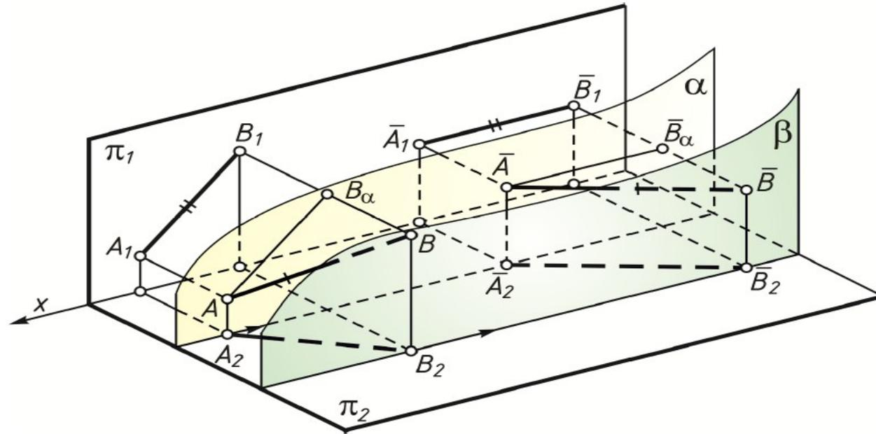
**Инвариантами** преобразования называются такие правила, позволяющие по проекциям данного положения предмета найти проекции его конечного положения
