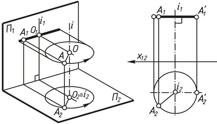
Окружность, описываемая точкой  $A$ , проецируется на плоскость  $\Pi_2$  без искажения, а на плоскости  $\Pi_1$  – в виде отрезка прямой. При вращении точки вокруг фронтально проецирующей оси, траектория точки проецируется на фронтальную плоскость проекций окружностью, а на горизонтальную плоскость – отрезком прямой, перпендикулярным оси.
