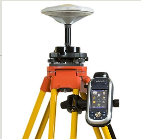
\_Одним из важных аспектов GPS по сравнению с обычными методами съемки является получение трех координат точек. Трехмерное положение точек получают с помощью засечек с искусственных спутников Земли.
