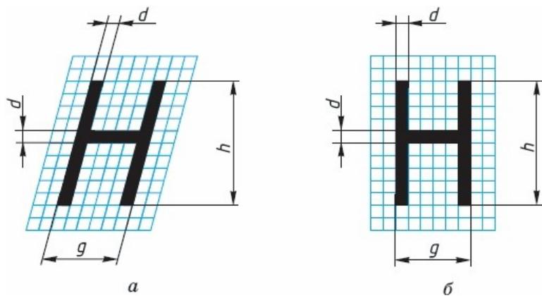
*Номер шрифта соответствует высоте ( $h$ ) прописной буквы. Например, шрифт № 5 имеет высоту прописной буквы, равную 5 мм.*
