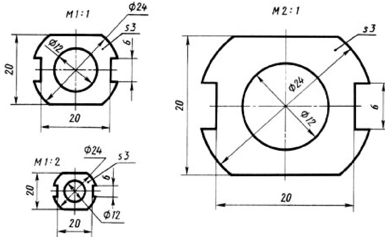
**При любом масштабе на чертеже наносят только действительные размеры !**
