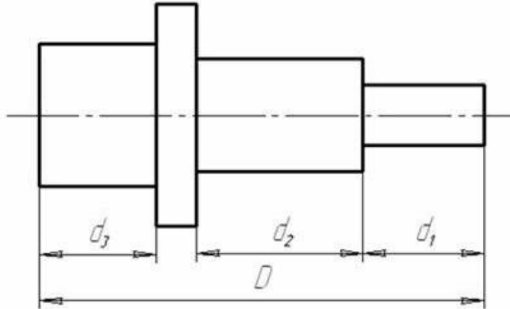
Размеры наносят по одной линии, цепочкой, один за другим. Метод характеризуется постепенным накоплением суммарной погрешности при изготовлении отдельных элементов детали. Это может привести к непригодности изготовленной детали.
