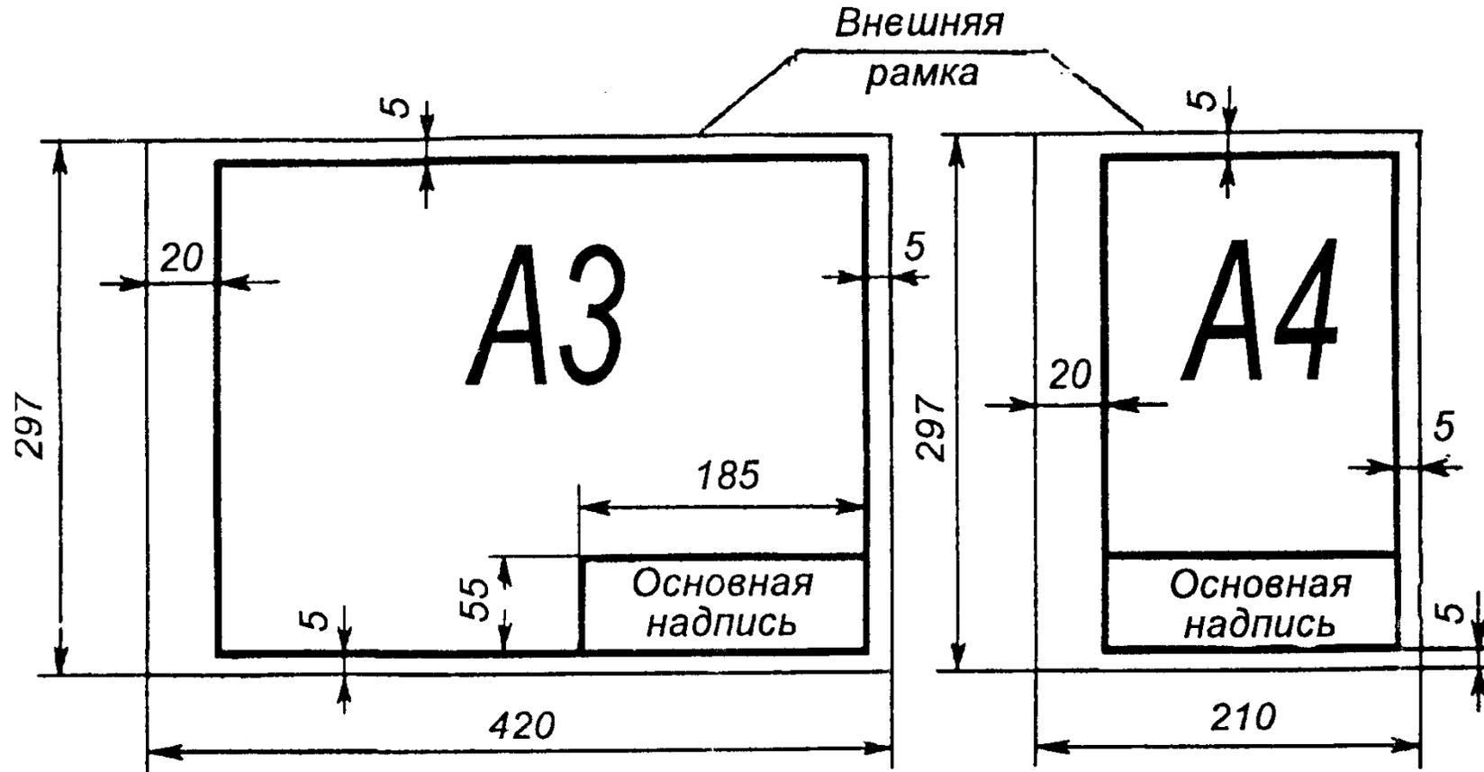
**Рамка.** Каждый чертеж имеет рамку, которая ограничивает поле чертежа. Рамку проводят сплошными толстыми основными линиями: с трех сторон на расстоянии 5 мм от края листа, а слева - на расстоянии 20 мм; широкую полосу оставляют для подшивки чертежей.
