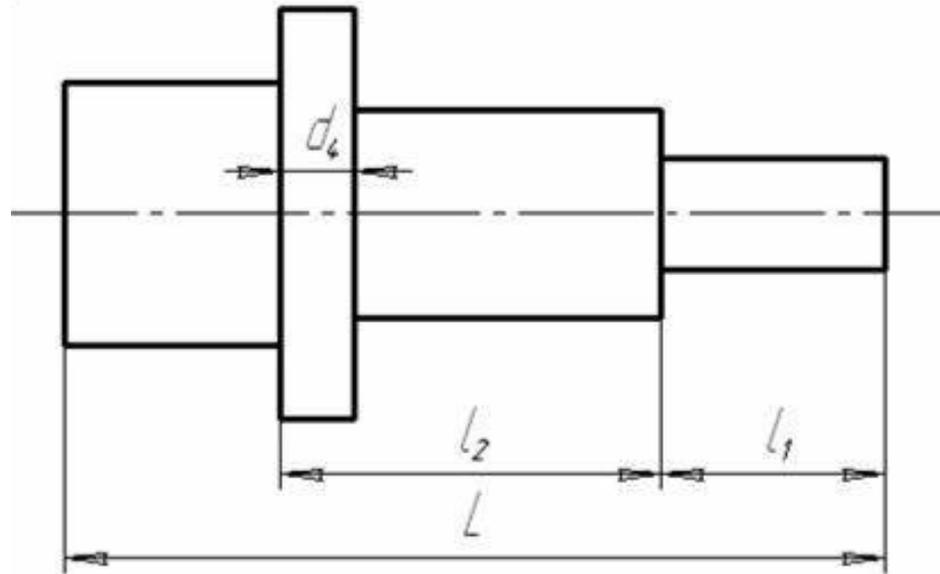
Наносить размеры на чертежах в виде замкнутой цепи не допускается: один из размеров должен быть «свободным», за исключением случаев, когда один из размеров является справочным
