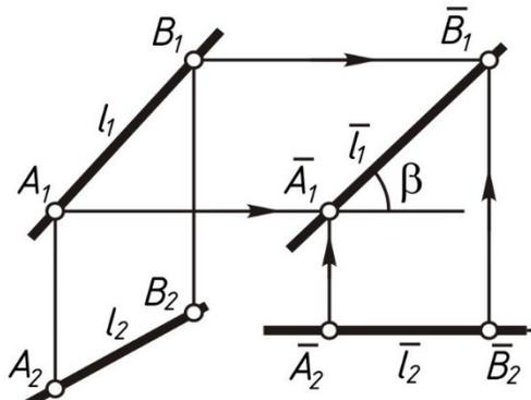
Если мы хотим прямую  $l$  сделать фронталью, то ее следует подвергнуть плоскопараллельному перемещению относительно  $\Pi_2$ .
