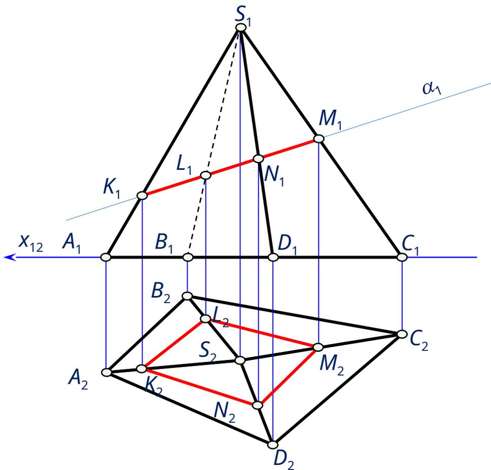
Построение сечений значительно упрощается, если *секущая плоскость является проецирующей*. В этом случае одна проекция сечения совпадет с проецирующим следом плоскости.
