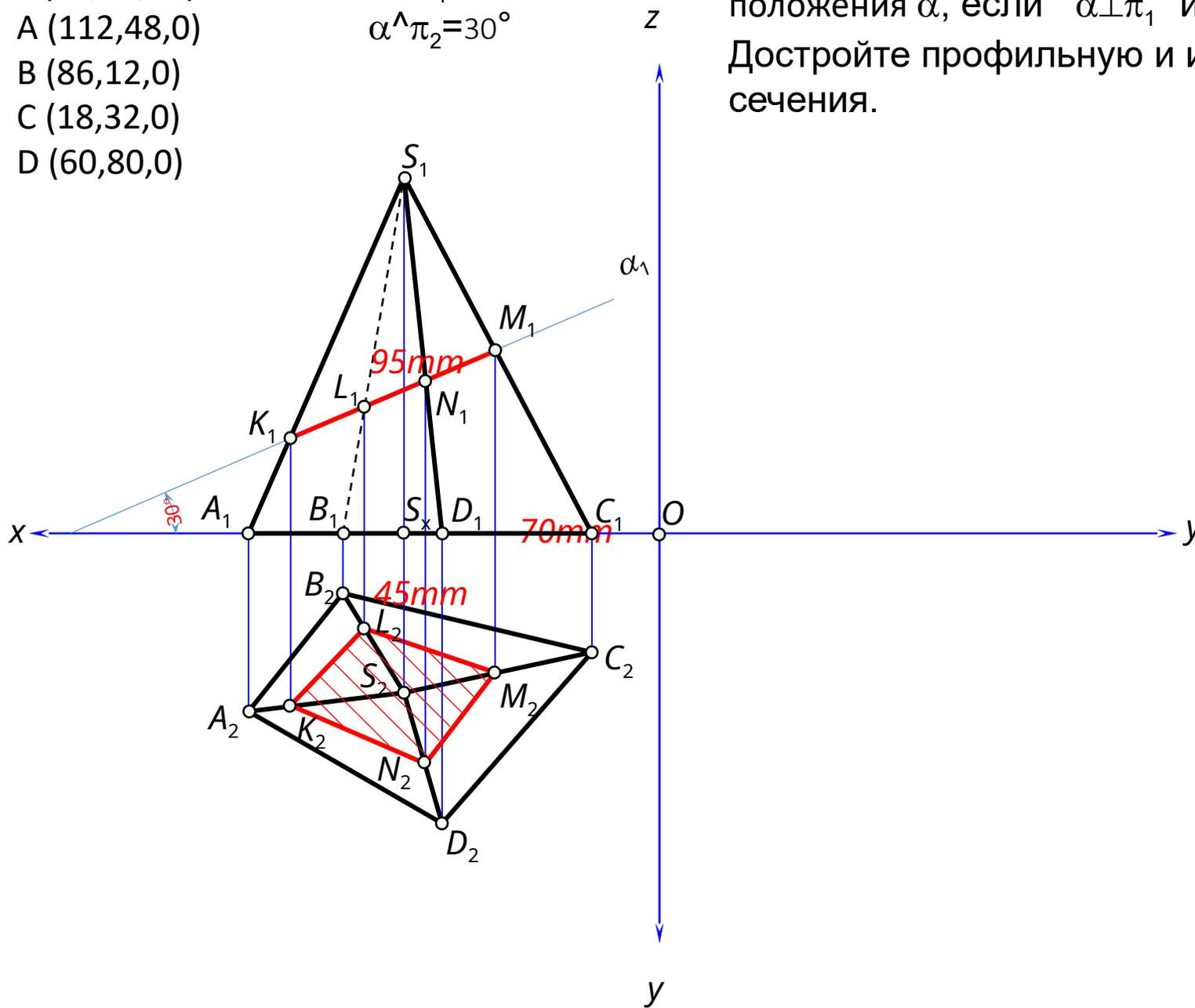
Задача. Построить сечение пирамиды плоскостью частного положения  $\alpha$ , если  $\alpha \parallel \pi_1$
