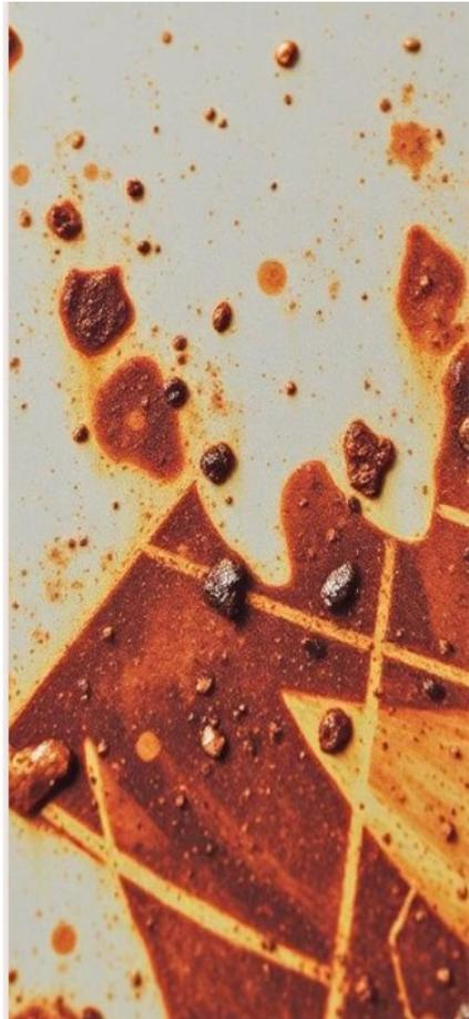
Металлические поверхности часто подвержены разным видам коррозии, которая может возникать как на микроскопическом, так и на макроскопическом уровне. Это связано с электрохимической неоднородностью материала, вызванной различиями в составе, структуре и условиях эксплуатации. Понимание причин и механизмов микро- и макрокоррозии имеет решающее значение для разработки эффективных методов защиты металлических изделий.
