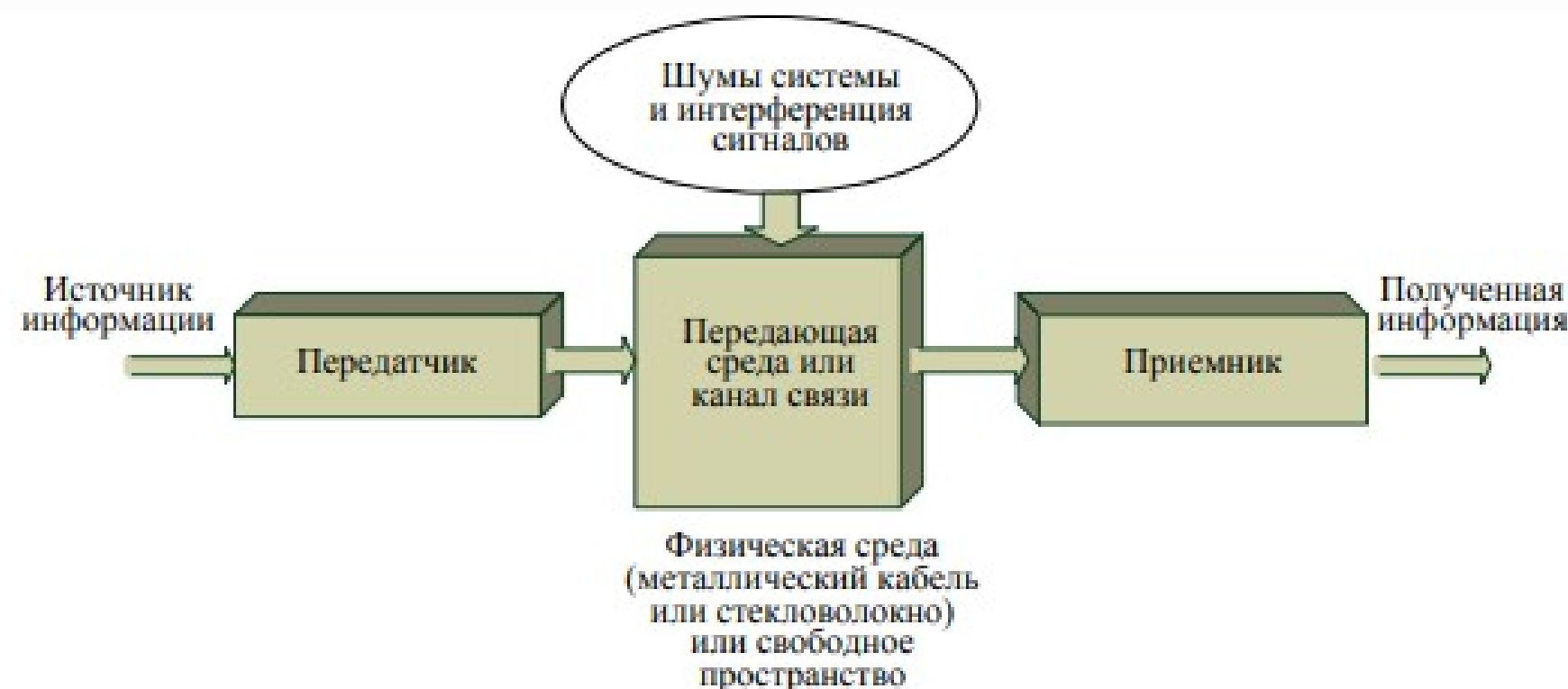
6.1-сурет. Телекоммуникация жүйесінің құрылымдық схемасы
