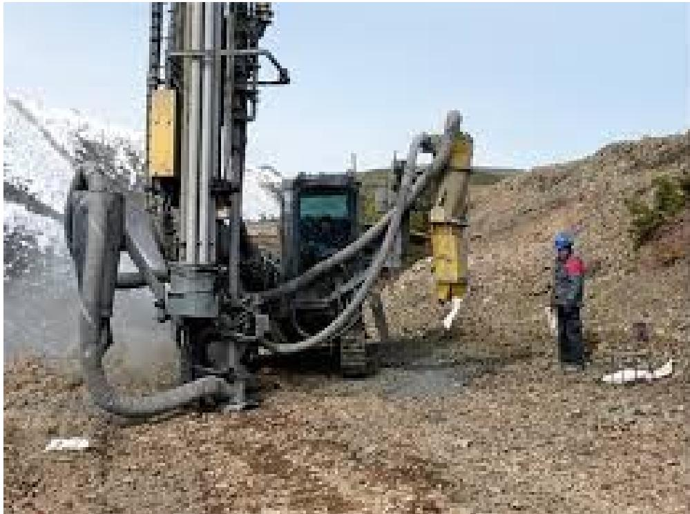
• Основные задачи сопровождающей эксплуатационной разведки заключаются в детальном оконтуривании типов руд и внутрирудных прослоев, изучении характера распределения основных полезных компонентов в рудах, проведении технологического опробования и картирования. По данным опробования буровзрывных скважин составляются проекты на массовые взрывы, осуществляются оперативное планирование и контроль добычи.
