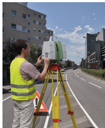
Рисунок 2 - Лазерный сканер Leica ScanStation C10: а) общий вид; б) работа со сканером
