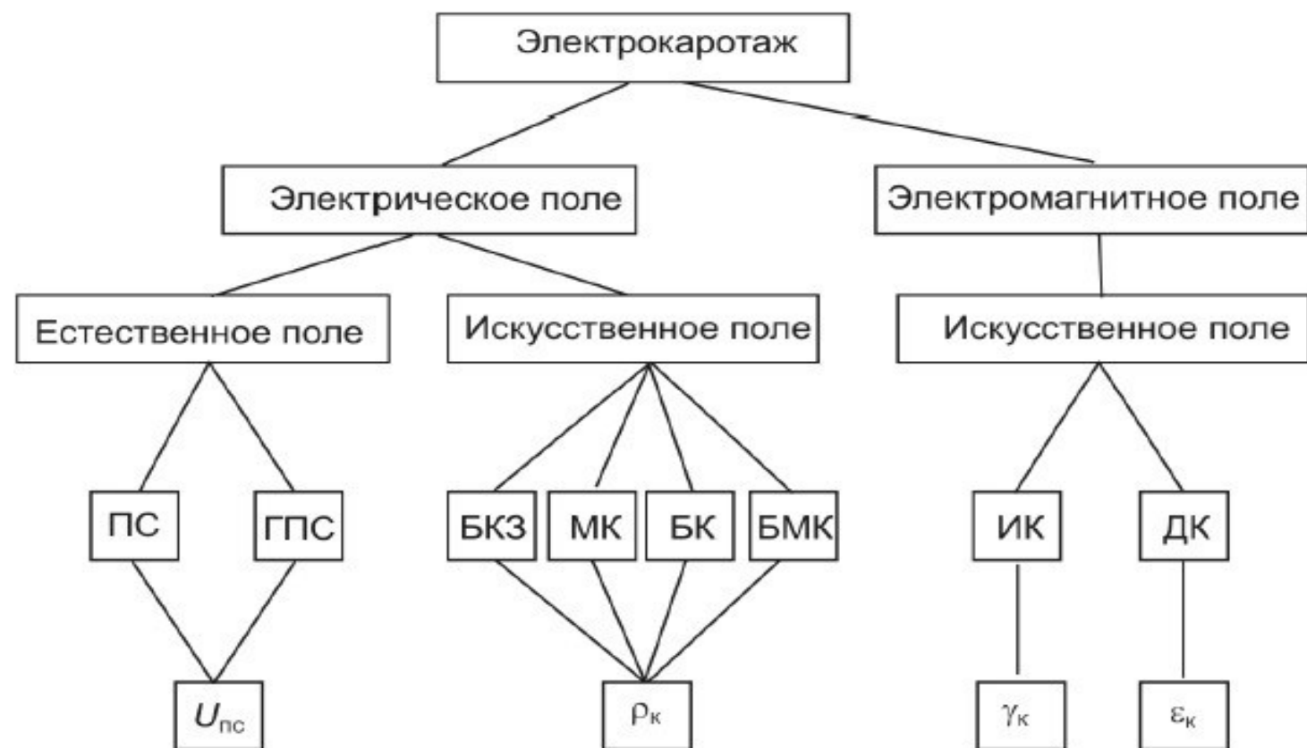
Рис. 4 Классификация электрических методов исследования скважин. Измеряемые величины: U_{пс} – потенциал самопроизвольной поляризации; \rho_k – кажущееся удельное сопротивление; \gamma_k – кажущаяся удельная про- водимость; \epsilon_k – кажущаяся диэлектрическая проницаемость
