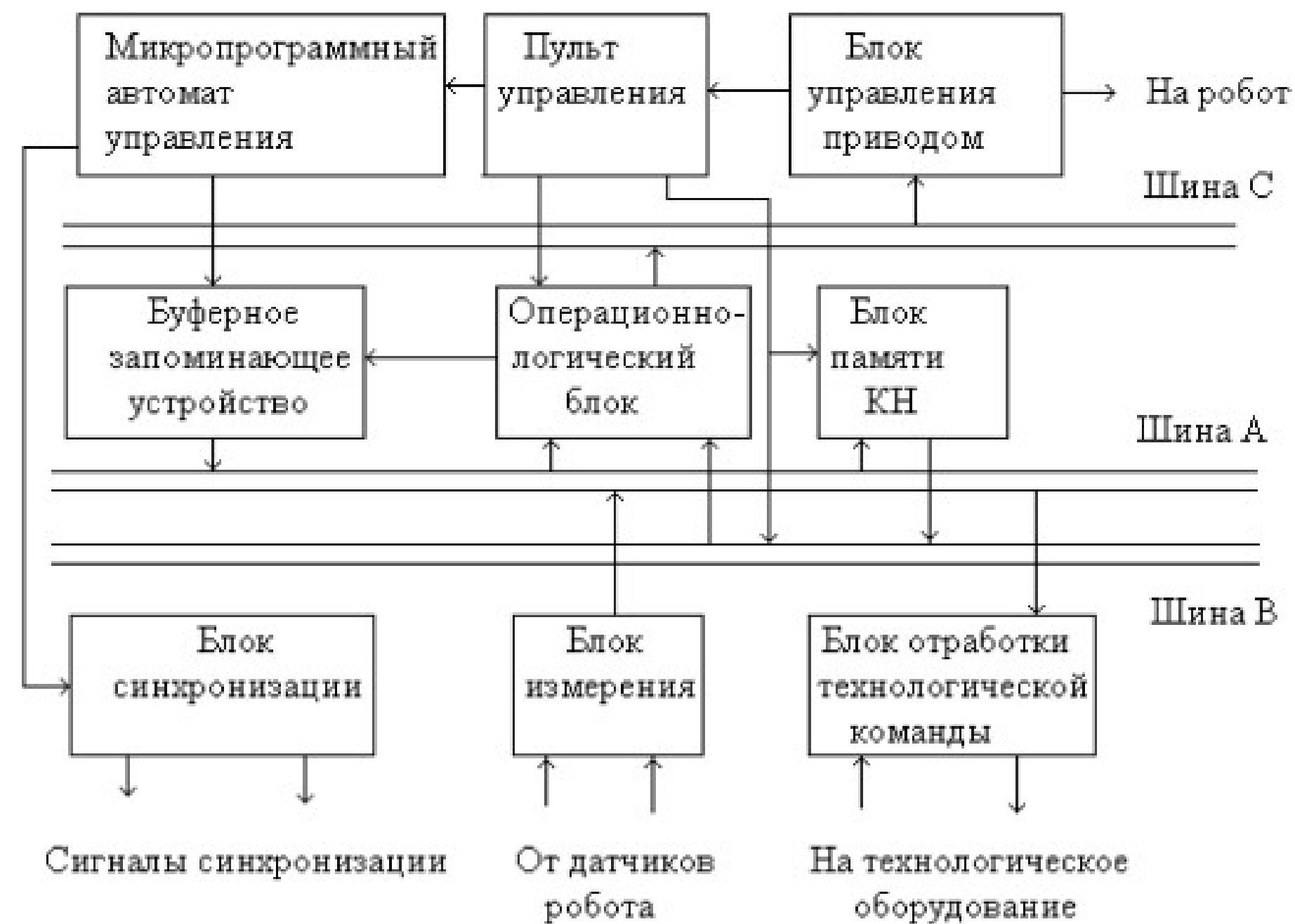
Рис. 5.7. Схема централизованной структуры позиционной системы программного управления.
