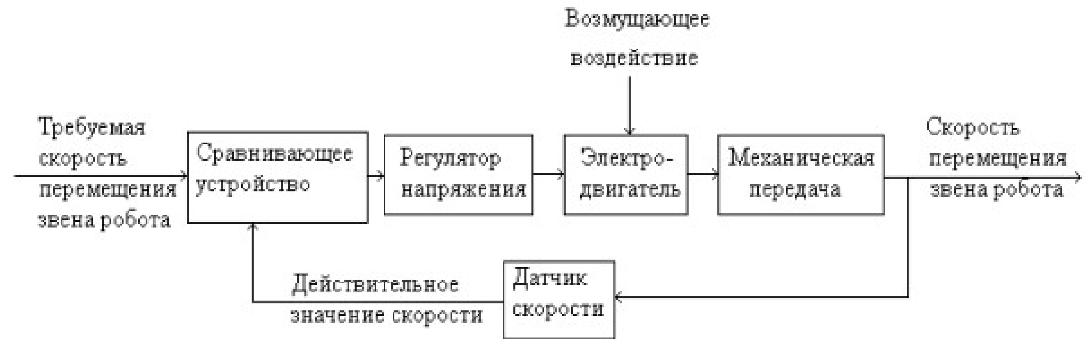
Рис. 5.3. Схема управления с обратной связью.
