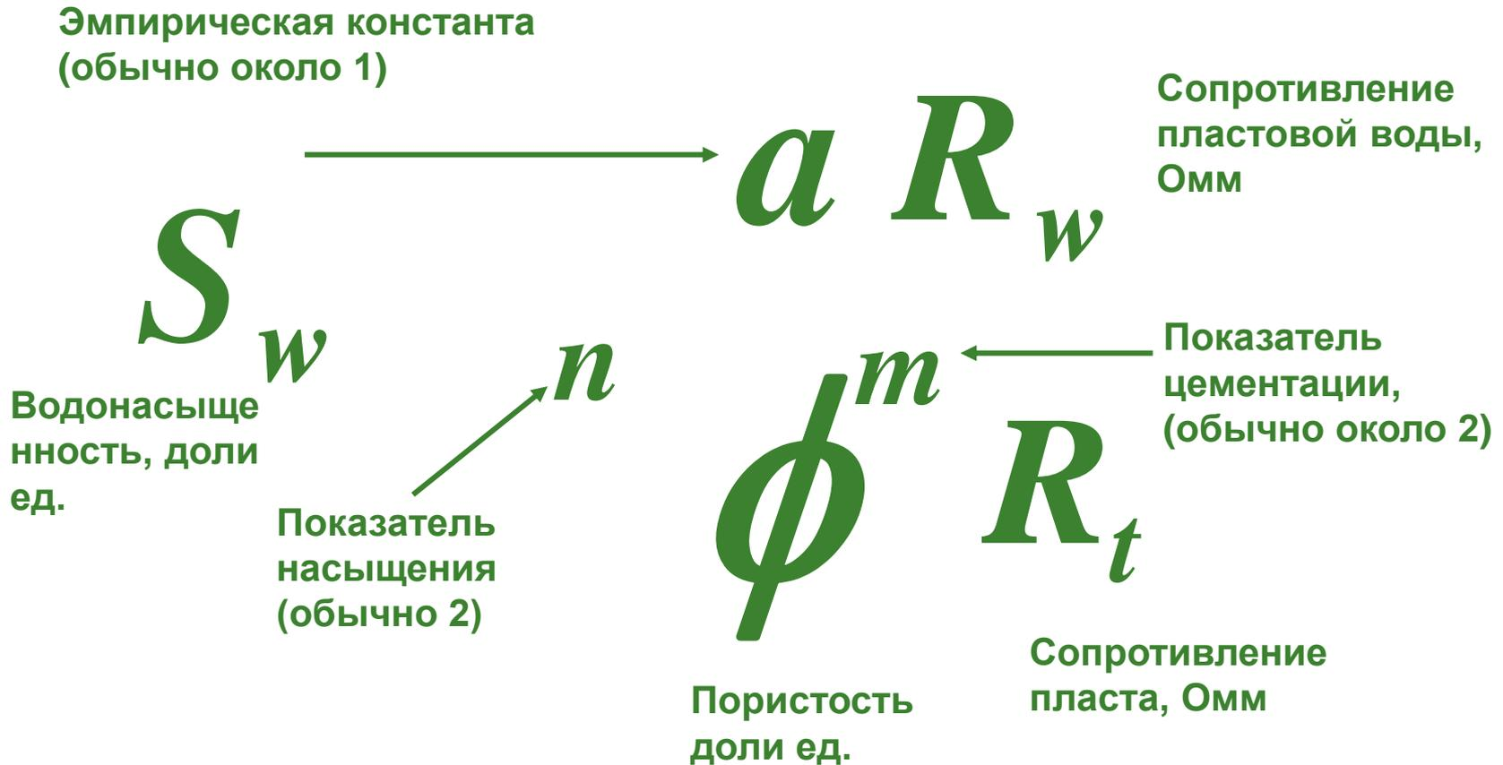
Удельное сопротивление породы  $\rho_{вп}$ , обладающей межзерновой пористостью, при 100%-м заполнении пор водой с удельным сопротивлением  $\rho_{в}$  оценивается соотношением
