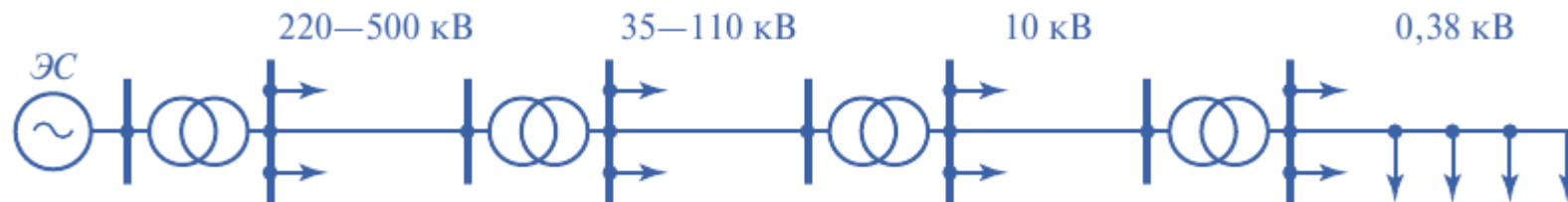
Схема передачи электроэнергии в сети
