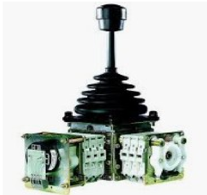
Рисунок 8. Командоконтроллеры а) типа ККТ-60 для кранов, б) многоосевой
