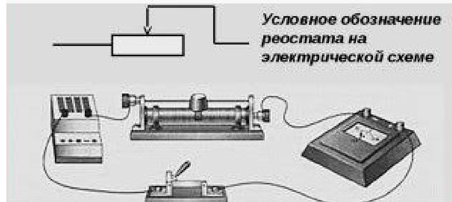
Рисунок 13. условное обозначение реостата.
