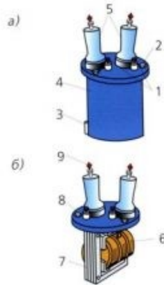
ОДНОФАЗНЫЙ ТРАНСФОРМАТОР НАПРЯЖЕНИЯ НОМ-10: а-общий вид; б-выемная часть; 1,5-проходные изоляторы; 2-болт для заземления; 3-сливная пробка; 4-бак; 6-обмотка; 7-сердечник; 8-винтовая пробка; 9-контакт высоковольтного ввода
