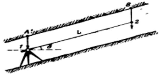
На рисунке показана схема измерения вертикального угла  $\delta$ . Под пунктом А центрируют теодолит, приводят его в рабочее положение, а в пункте В подвешивают отвес, на котором отмечают точку 2. Поскольку расстояние  $L$  измеряется по направлению от оси вращения трубы 1 до отмеченной точки 2, то и угол наклона  $\delta$  должен быть измерен в этом же направлении.
