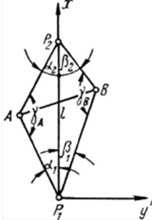
Таким образом, вводят условный азимут направления P1P2. Дальнейший ход решения следующий. Вычисляют координаты отвеса А в условной системе координат. Для этой цели определяют расстояния AP1 и AP2. Из треугольника P1AP2 имеет:
