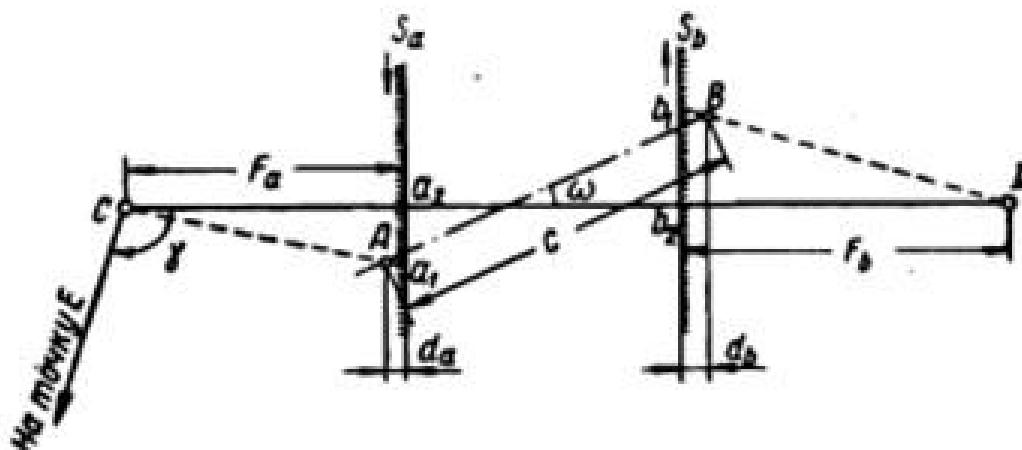
А и В -- отвесы; С и D -- точки стояния инструментов;
