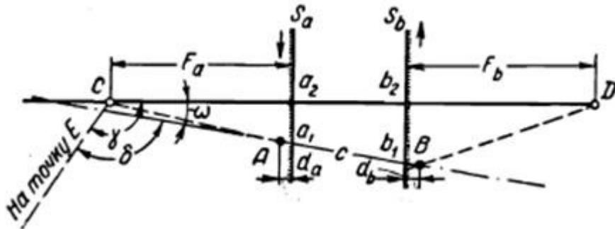
Установка теодолитов в точках С и D производится возможно ближе и под возможно меньшим углом со относительно створа отвесов. Расстояние от инструментов до шкал должно быть не более 5--6 м.
