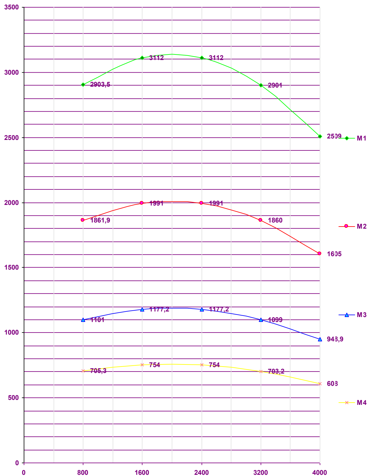
Рисунок 1. График зависимости крутящего момента на ведущих колёсах от скорости автомобиля (без включения демультипликатора).
