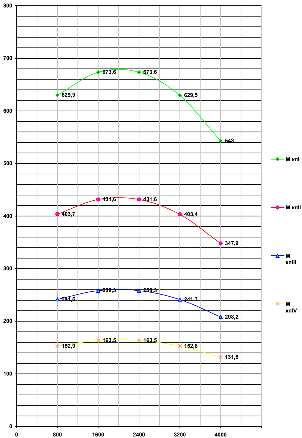
Рисунок 4. График изменения крутящего момента на выходном валу коробки передач.
