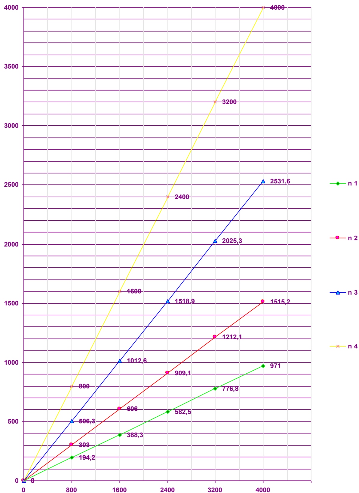
Рисунок 3. График зависимости частоты вращения коленчатого вала двигателя от передаточного числа коробки передач на выходном валу коробки передач.
