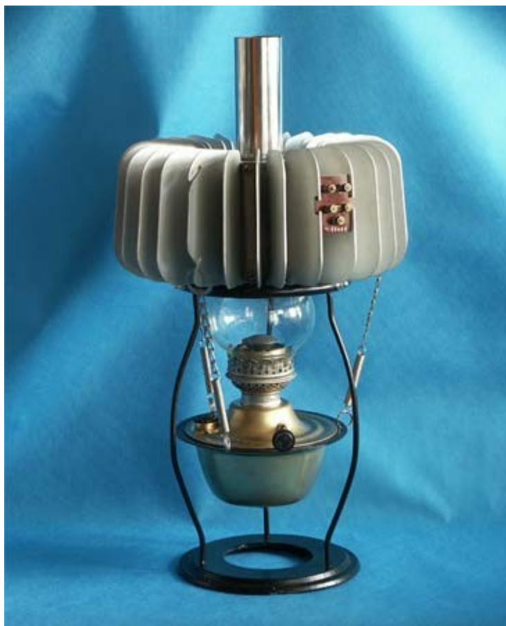
Рисунок 6. Внешний вид термобатареи
