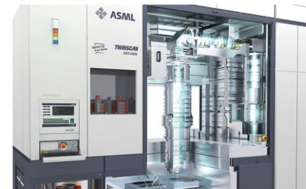
фото 2. Традиционный проекционный фотолитограф компании ASML. В центре виден объектив
