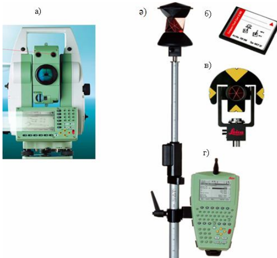
80-сурет. TCR1205 тахеометрі, оның қосымша құрал-жабдықтары:
