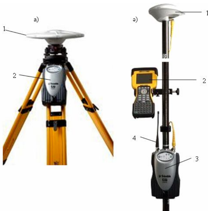
87-сурет. Trimble R7 GNSS жүйесінің технологиясы: а) – базалық станция: 1-антенна; 2-қабылдағыш; ә) – Далалық ровер: 1-антенна; 2-контроллер; 3-қабылдағыш; 4-радиоимodem антеннасы
