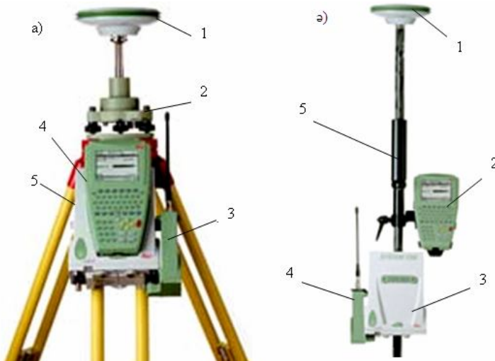
90-сурет. а) Штативке орнатылған базалық станция: 1 - антенна; 2 - трегер; 3 - радиомодем; 4 - контроллер; 5- қабылдағыш (GPS1230); б) қадаға орнатылған далалық ровер: 1-антенна; 2- контроллер; 3- қабылдағыш; 4 - радиомодем; 5 - қада
