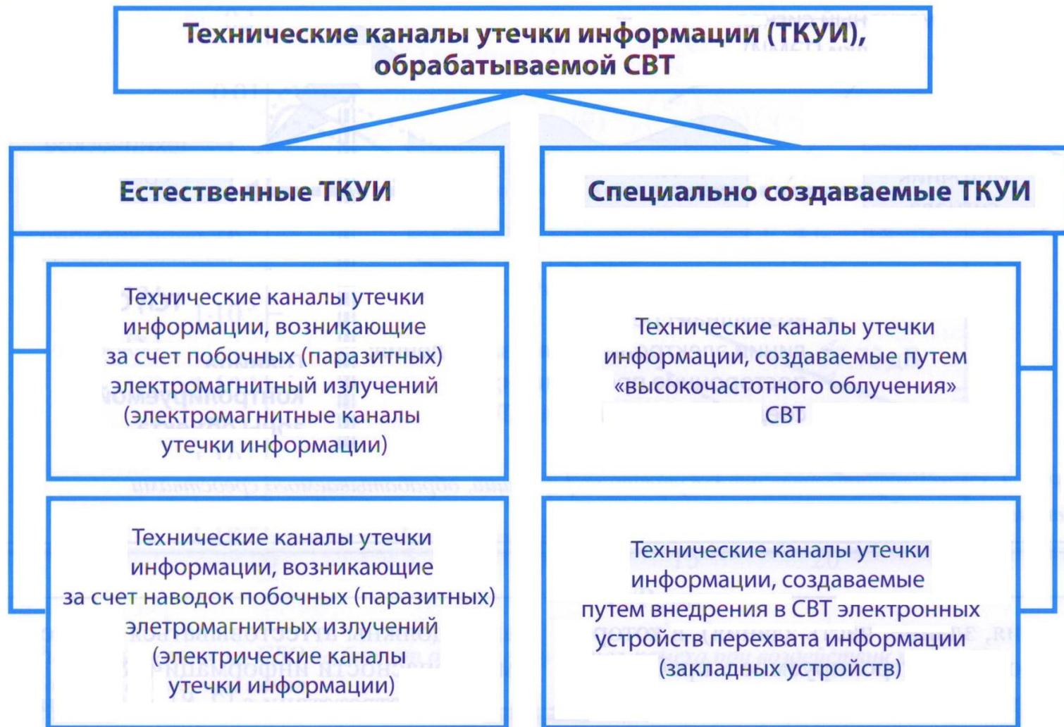
*Классификация технических каналов утечки информации, обрабатываемой средствами вычислительной техники (СВТ)*
