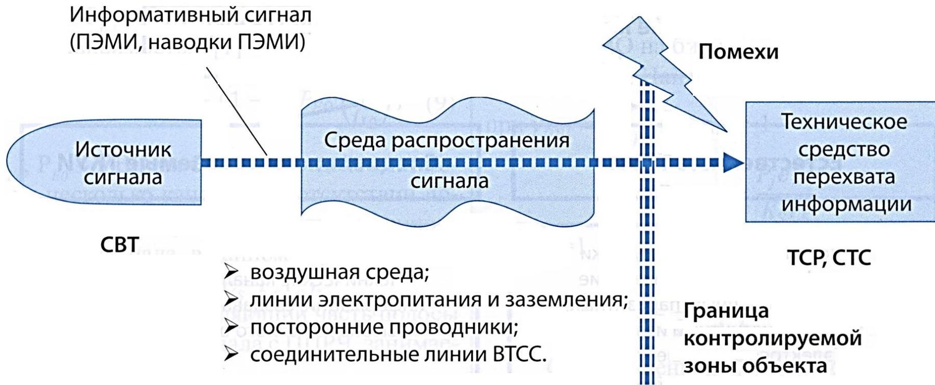
*Схема технического канала утечки информации, обрабатываемого средствами вычислительной техники*
