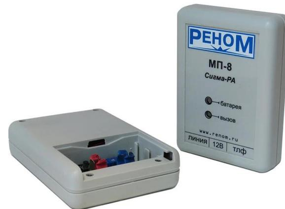
Устройство защиты телефонных аппаратов МП-8 «Сигма-РА»
