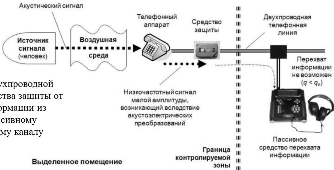
Схема установки в двухпроводной телефонной линии средства защиты от утечки речевой информации из помещения по пассивному акустоэлектрическому каналу
