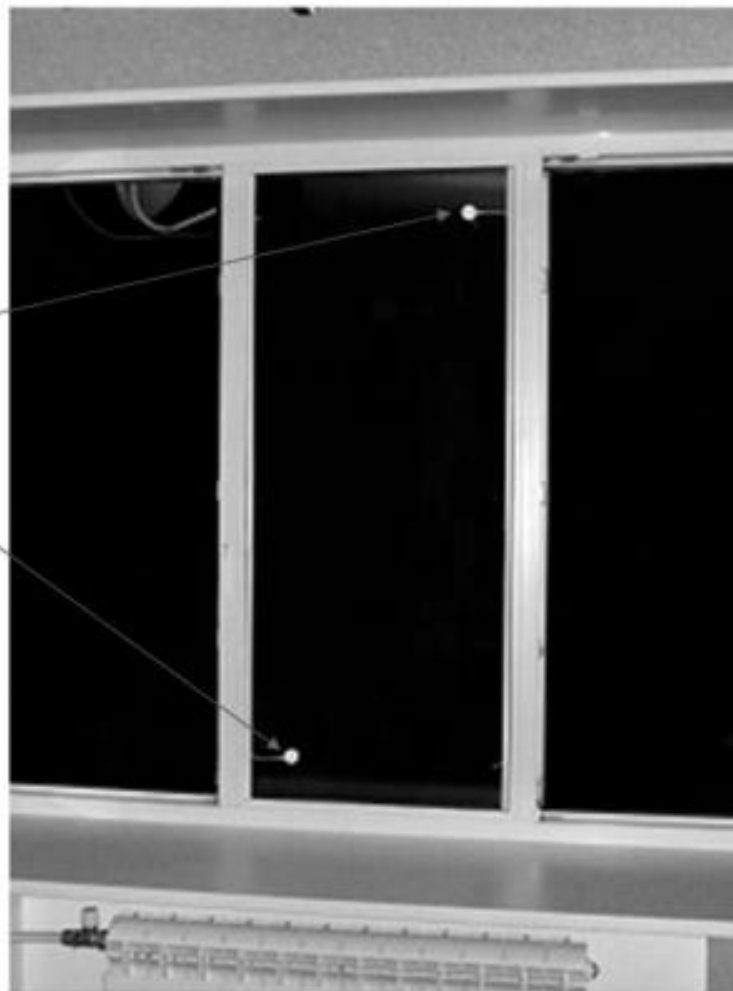
Пример установки 2-х виброизлучателей на оконном стекле
