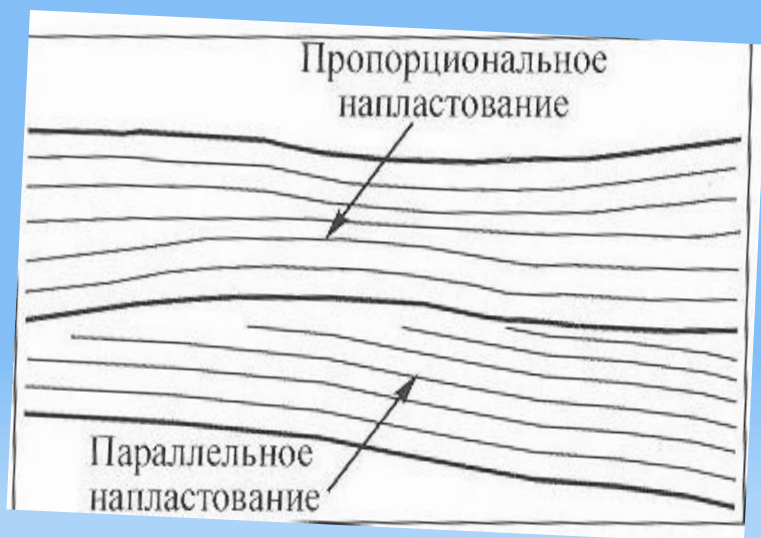
Рис.3.11. Схема залегания осадочных пород, используемая в качестве основы для построения стратиграфической сетки
